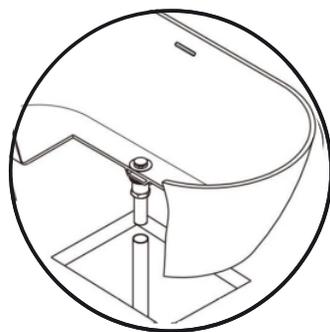
7. Positionner soigneusement la baignoire et connecter le drain à la plomberie (précédemment installé). Terminer l'installation de la pièce de montage.
