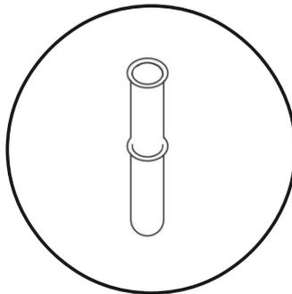
4. Fixer le filetage de tuyau femelle de 1 1/2 pouce au drain mâle de la baignoire de 1 1/2 pouce (tuyau femelle non-inclus).
