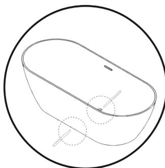
1. Nettoyer, niveler et préparer le sol pour l'installation. Placer le bain à l'emplacement approprié au sol et tracer le contour de la baignoire à l'aide d'un crayon ou d'un marqueur. Tracer ensuite l'emplacement du drain sur le sol.
