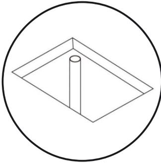
3. Avant de percer un trou dans le plancher pour le tuyau d'évacuation, assurez-vous qu'il n'y a aucun élément en dessous (tuyaux, joints de plancher, conduits de chauffage, fils électrique).
