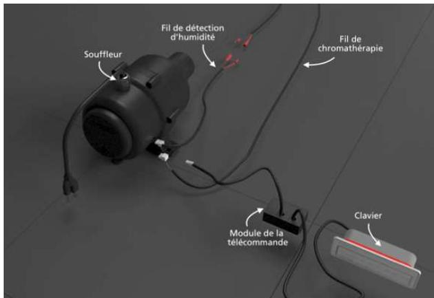
6. Procéder au branchement des 2 sections du fil de détection d'humidité. S'assurer d'aligner les couleurs identiques ensemble.
