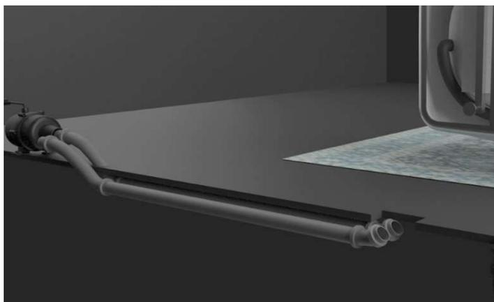
**12.** Passer 2 conduits de ABS ou PVC 1 ½" sous le plancher entre le souffleur et la baignoire.
