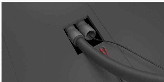
**16.** À l'endroit où se trouve le souffleur, procéder aux branchements finaux des connexions et au raccordement de la sortie d'air du souffleur à l'aide de conduits de 1 ½".
